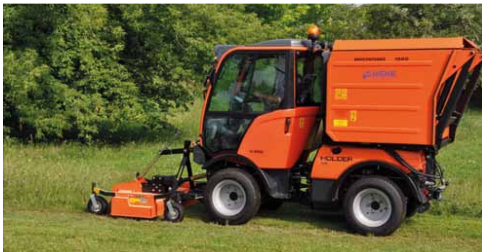
Holder C250 met Stensballe-maier en Wicke Mähcontainer 1500
