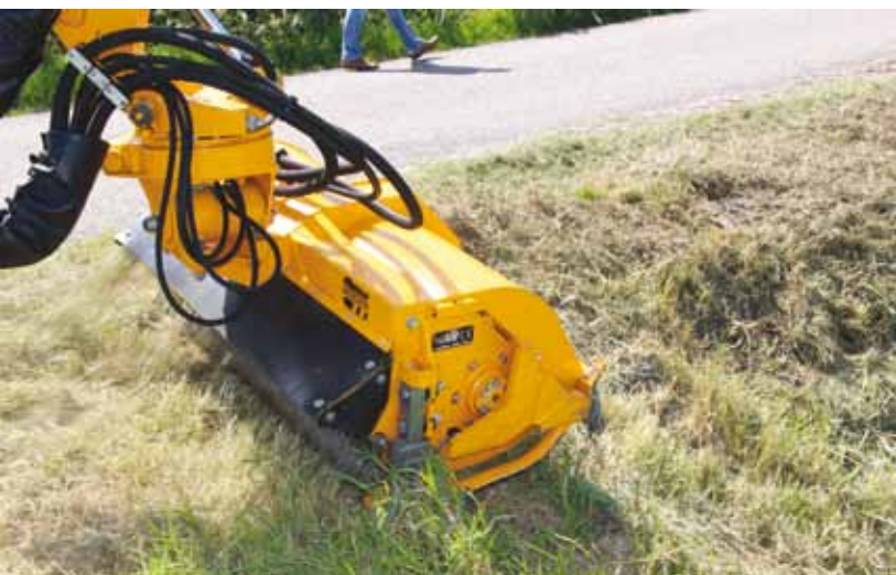
De maaïarm van de Muskietier is uitgerust met het moderne bedieningssysteem Nivo-tronic. Dit systeem werkt met een volautomatische zweefstand.
