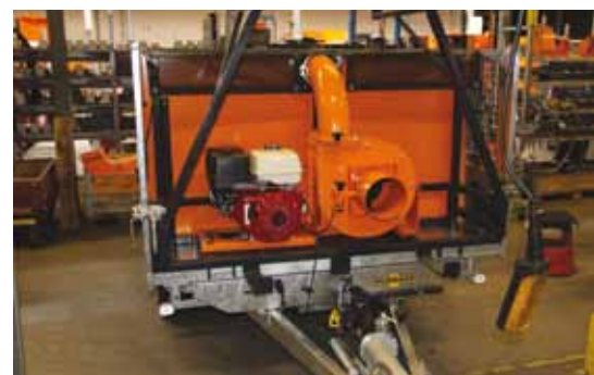
Een omgebouwde Humbaur-aanhanger die uitgerust is met een Votex zuigunit 521M.
