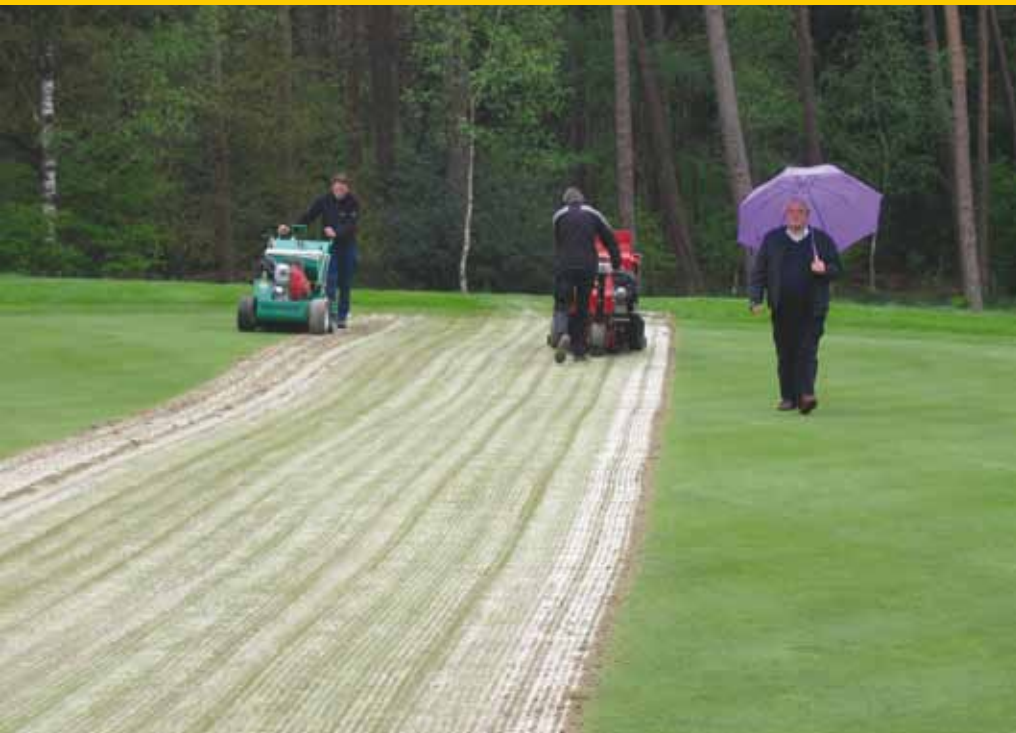
Vos Ruinenwold in actie met de Graden verticuteermachine met zandinjectie tijdens verbetering van de toplaag op de Hilversumse.
