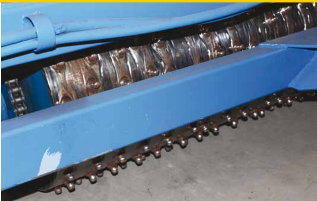
De machine met de noppen, waarmee Innoseeds de intensieve betreding simuleert. Driemaal per week!
