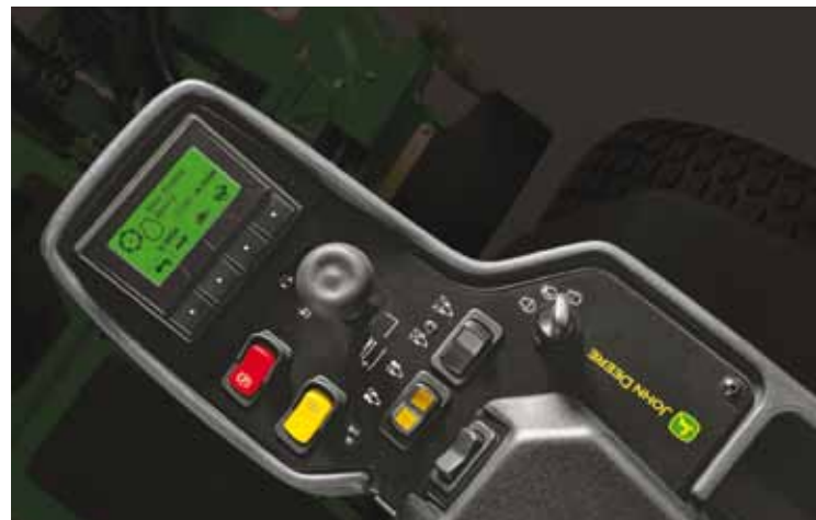
Een andere aanpassing is dat de bedieningsconsole van alle A-modellen nu vastzit aan de stoel, waardoor hij meebeweegt met de stoel. Naast TechControl en LoadMatch zit op een deel van de nieuwe maaimachines ook de modernste elektrische hybride-technologie, bij John Deere 'E-Cut maaiers' geheten.
