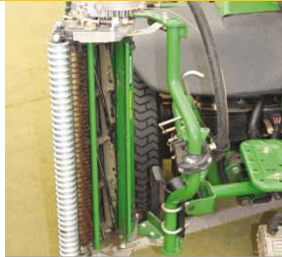
De tweede generatie elektrische maaiers met het unieke Quick Adjust (QA). Een van de verbeteringen is dat de nieuwe maaikooien het gras beter verspreid uitwerpen. Een van de aanpassingen bij de 7200A PrecisionCut is dat de maaiers nu sideshift hebben, waardoor de kans op beschadigingen aan de baan nog kleiner wordt.
