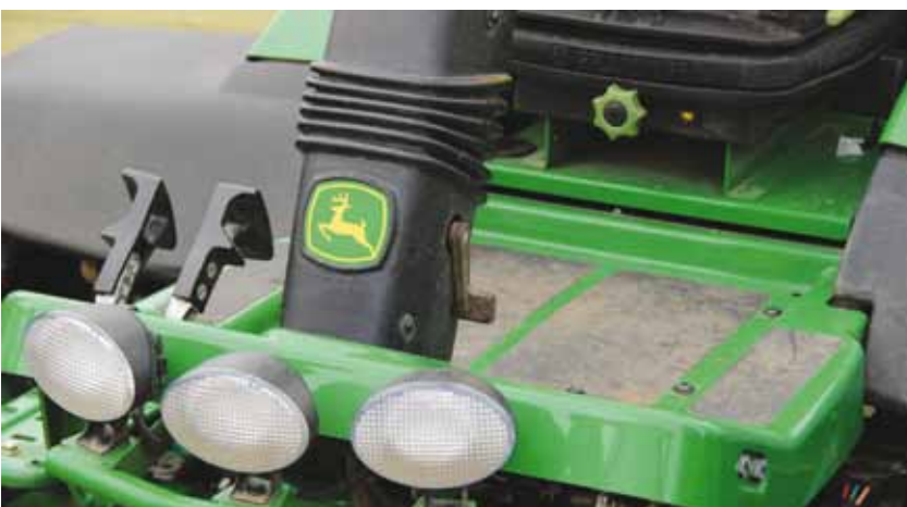
Doordat de voorkant van de ondersteuningsplaat voor de voeten nu aan de voorkant meer omhoog staat, kan de chauffeur zijn voeten makkelijker plaatsen en heeft hij meer steun.
