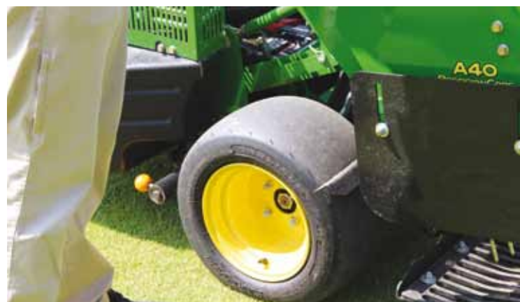
Nog een nieuwtje bij de A40 en V40 is de breedte van de banden. Doordat de banden nu smaller zijn en niet meer buiten de machine steken, kan er bijvoorbeeld geen 'schade' meer optreden aan de green of tee als je op de fairway bezig bent.
