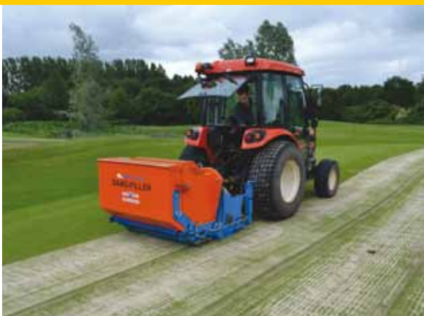
Driepuntsophanging van de machine. Een krachtbron van 45 pk volstaat bij een sleufdiepte van 2,5 cm.
