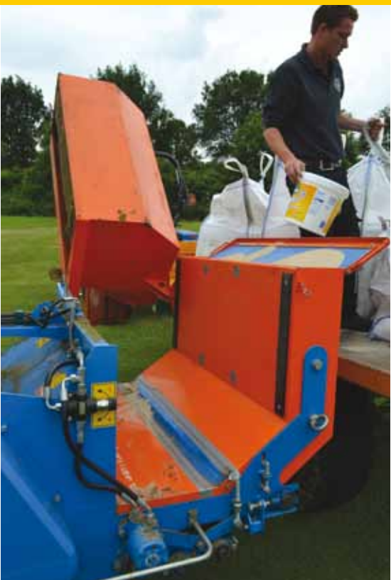
De Sandfiller heeft twee bunkers: één voor droog zand en één kiepbare. In de laatste worden vilt en grasresten verzameld.
