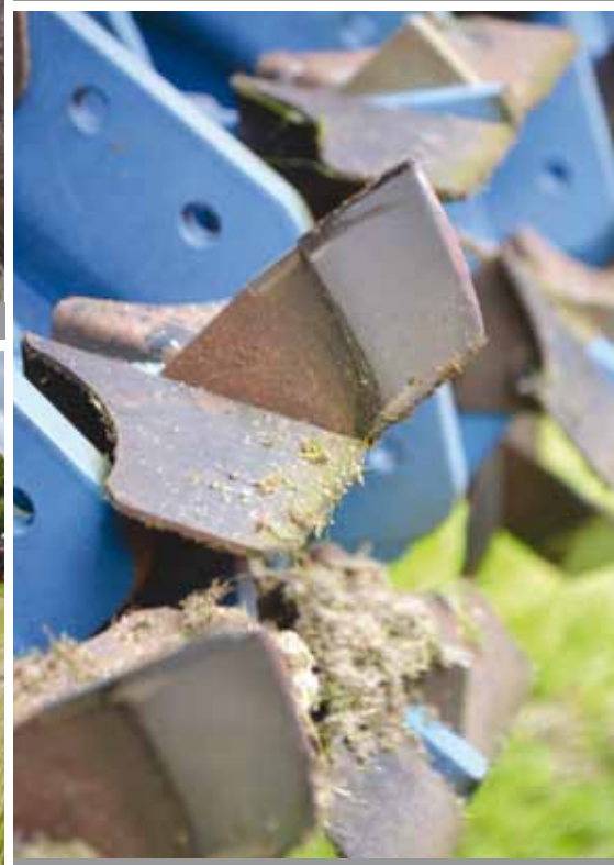
De messen van de Sandfiller. Plaatjes zorgen voor de benodigde luchtverplaatsing om het verticulaat af te voeren.
