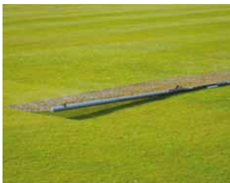
Bij deze ondulatie blijft de mat contact houden met het gras.
