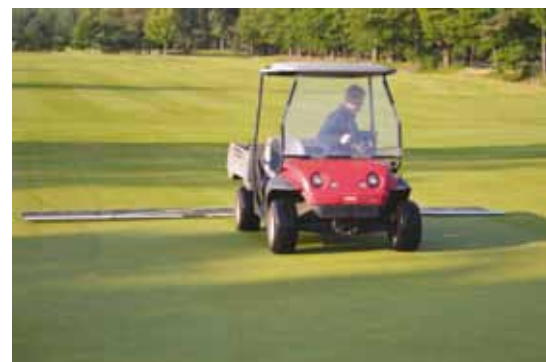
De zes meter brede constructie met mat kan ook dienst doen om zand in te slepen.
