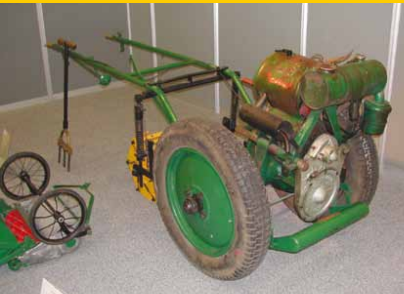
Op deze machine lijkt een restant van een Ransomes-logo zichtbaar. Wat bouw van de machine betreft lijkt de tractie-unit erg op die van de Overgreen greens mower. De machine hier op de foto is uitgerust met een penbeluchter. Een soortgelijke machine was uitgevoerd als kantensnijder om bijvoorbeeld in te zetten bij het onderhoud van wegbermen.
