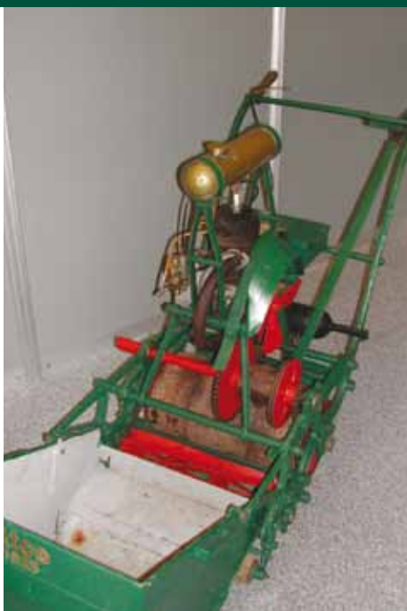
Atco Standaard. Ze werden aangedreven door een 70 cc Villiers motor. Het bouwjaar: circa 1925.
