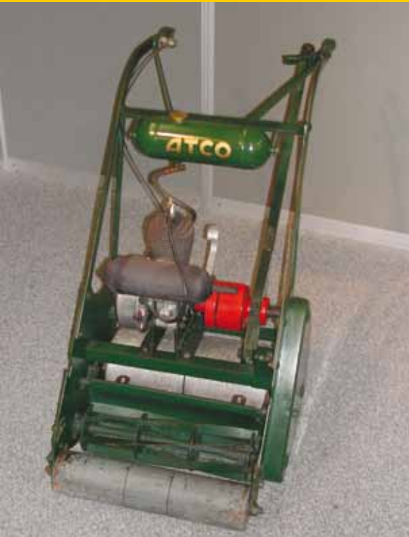
Eveneens Atco's. Het is een wat later model dan de andere foto's, waarschijnlijk uit de jaren vijftig van de vorige eeuw. De machine is wat handzamer geworden en de draaiende delen zijn beter afgeschermd. De vooruitgang in de metaaltechniek is ook goed zichtbaar op deze foto's, steeds meer gietijzeren delen zijn vervangen door buismateriaal en hoeklijn.
