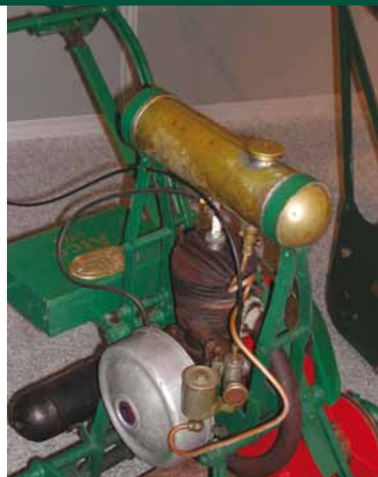
Atco Standaard. Ze werden aangedreven door een 70 cc Villiers motor. Het bouwjaar: circa 1925.
