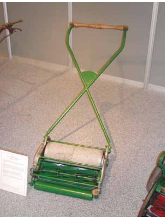
Een doorontwikkelde achterrol-aangedreven machine. De aandrijving is hier netjes weggewerkt achter een beschermkap.
