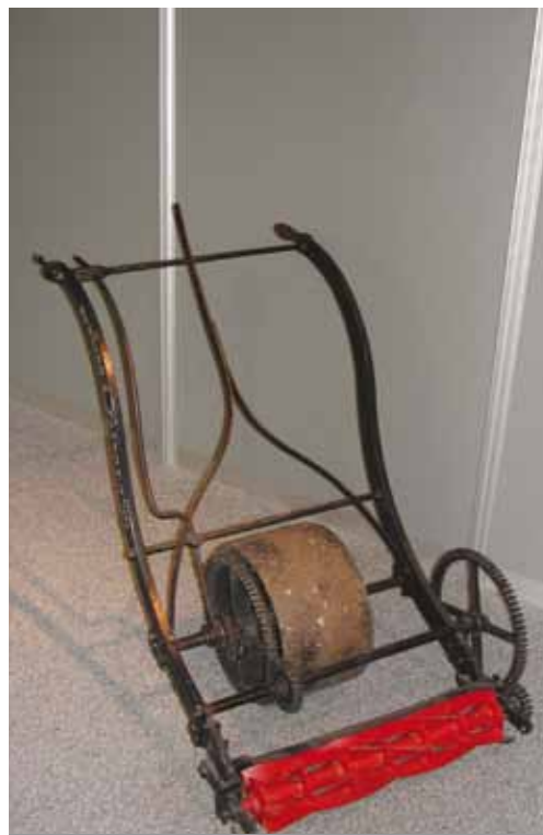
Eén van de eerste door Ransomes geproduceerde maai-machines, een uitvinding van Edwin Budding uit 1830.
