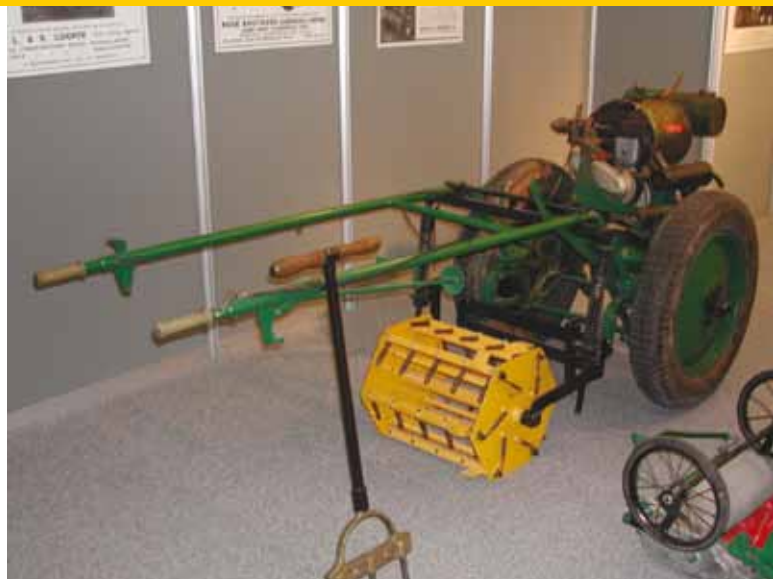
Op deze machine lijkt een restant van een Ransomes-logo zichtbaar. Wat bouw van de machine betreft lijkt de tractie-unit erg op die van de Overgreen greens mower. De machine hier op de foto is uitgerust met een penbeluchter. Een soortgelijke machine was uitgevoerd als kantensnijder om bijvoorbeeld in te zetten bij het onderhoud van wegbermen.
