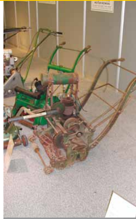
Het merk en type van deze machine zijn mij onbekend. Het is mooi om te zien dat men de aandrijving van de snijcilinder via tandwielen door de achterrol heeft vervangen door een verbrandingsmotor.
