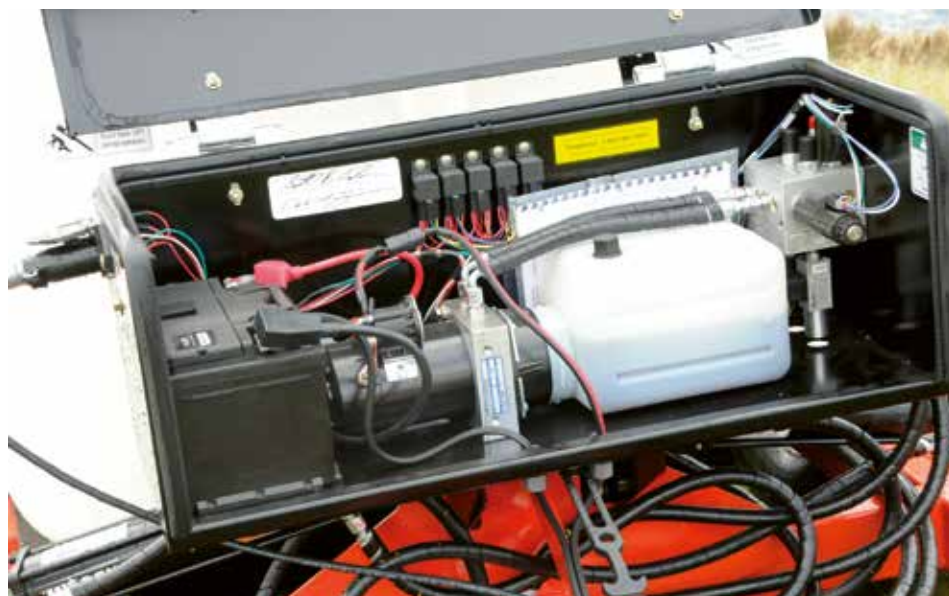
'Onder de kap' van de Smithco-fairwayroller is niet veel te zien: een eigen accu en een eenvoudig hydrauliektankje.
