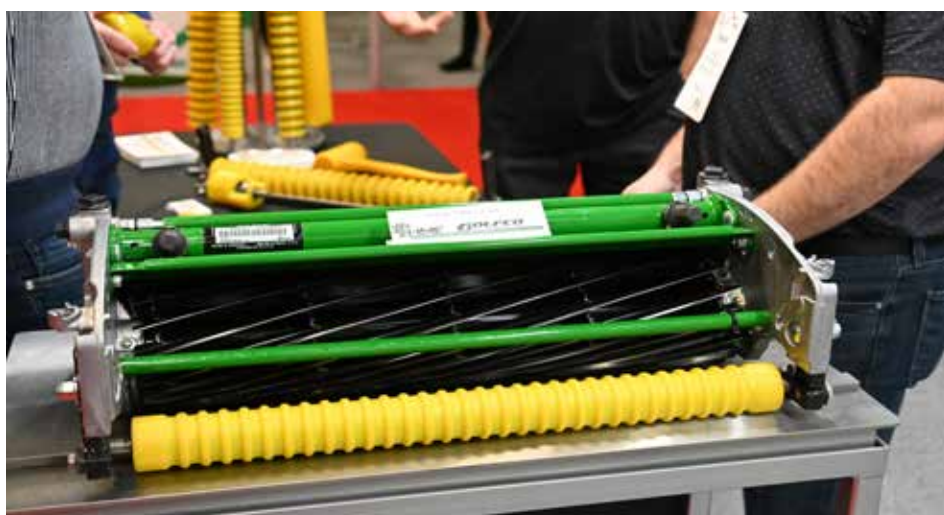
GOLFCO-rollers, niet uit staal, maar uit polyurethaan
